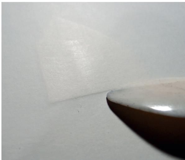
Um eine scharfe Linie zu erzeugen muss mit dem Falzbein so nah an die Schablone gerieben werden, dass dort eine Prägung entsteht.
